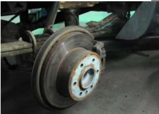
*Scheiben und Bremsklötze der Hinterradbremse sowie Bremsbacken der Feststellbremse müssen erneuert werden.*
