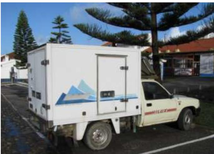
Dieser Toyota Hilux treibt vier Räder an. Der Aufbau dient dazu, Fische vom Hafen zu holen und zu verfrachten. Um den isolierten Kasten zu reinigen, sind an allen vier unteren Ecken Schlauchauslässe angebracht.
